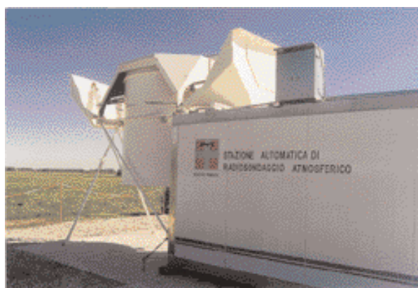
Figura 6.15 - Il sistema di radiosondaggio automatico della Regione Piemonte
