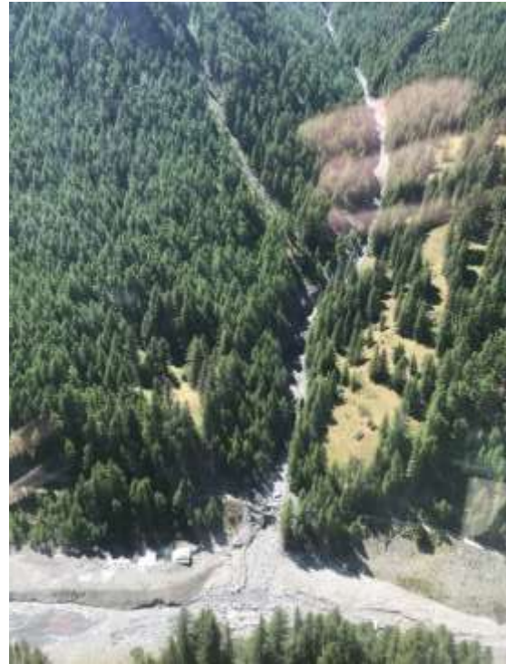
Figura 47 – Rio di Pont Terrible: canali di erosione nelle falde detritiche dell'alto vallone (a sinistra, foto CFAVS) e sormonto della strada comunale (a destra, SX1 in Figura 46).
