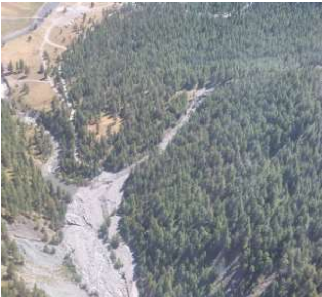
Figura 52 – Vallone Vallonet, versante sinistro della Valle Argentera, al margine inferiore della piana delle Brusa (SX9 in Figura 46): importante trasporto solido lungo l'asta alimentato anche dall'attivazione di alcune erosioni di versante (a destra, foto CFAVS) e deposizione in fondovalle di un ampio accumulo detritico (a sinistra, foto CFAVS).
