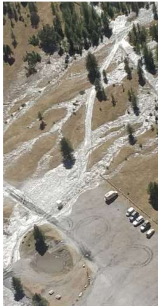
Figura 54 – Incisione sul versante sinistro della Valle Argentera in corrispondenza di Brusa del Plan (SX10 in Figura 46): area di origine della colata, in corrispondenza di rocce fratturate posizionate tra 2000 e 2200 m di quota (a sinistra, foto CFAVS); divagazione della piena con limitato apporto detritico lungo il conoide, a lambire l'area di sosta dei camper (a destra).
