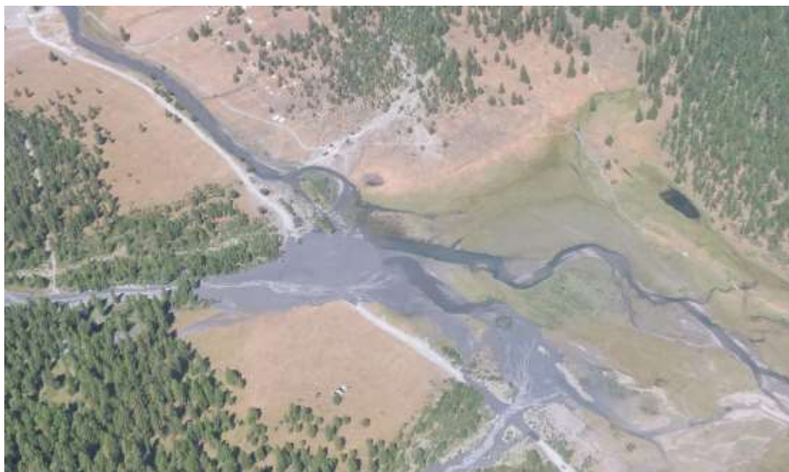
Figura 55 – Incisione del rio della Pissa, versante sinistro della Valle Argentera: area di origine della colata, in corrispondenza dell'impluvio impostato in detriti e rocce fratturate in una fascia compresa tra 2200 e 2700 m di quota (a sinistra, foto CFAVS); sul conoide, a quota 1830 m circa, fuoriuscita dall'alveo e divagazione della colata con ingente apporto detritico in corrispondenza dell'attraversamento stradale (foto in alto a destra, posizione SX11 in Figura 46). La colata si è arrestata con un evidente lobo in corrispondenza dell'alveo del torrente Ripa (in basso, al centro dell'immagine, foto CFAVS).
