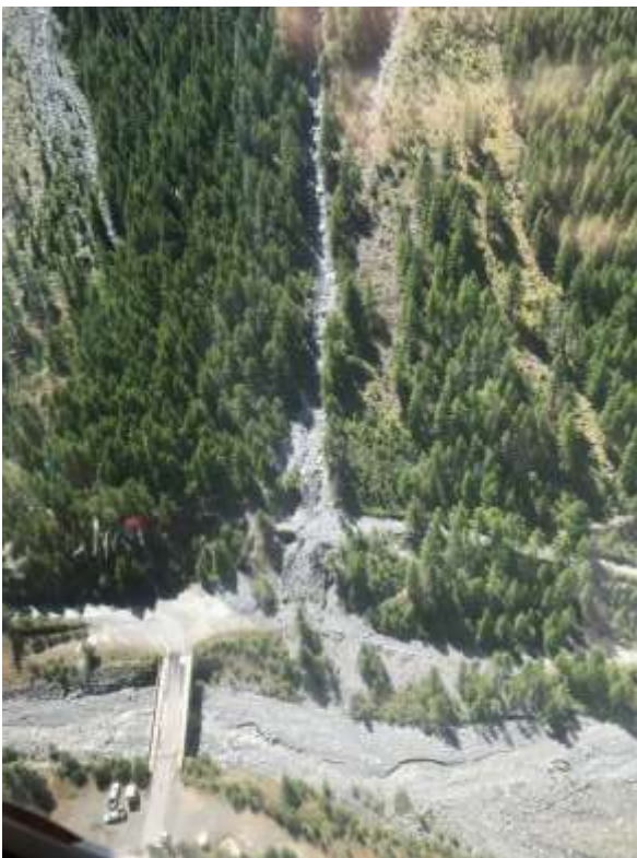
Figura 48 – Incisione in sinistra subito a valle di Pont Terrible (SX2 in Figura 46): sormonto della strada comunale (foto CFAVS).
