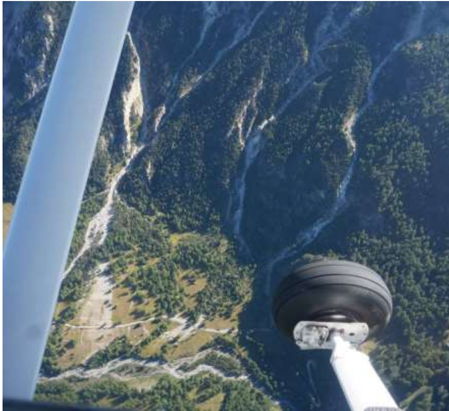
Figura 58 – Lungo il versante destro della Val Thuras si sono attivate le aste torrentizie che scendono dal massiccio Furgon - Gran Roc - Roc del Boucher determinando alcune colate detritiche che hanno raggiunto la strada comunale in località Croix del la Plane, posizione indicata con VT1 e VT2 in Figura 46.
