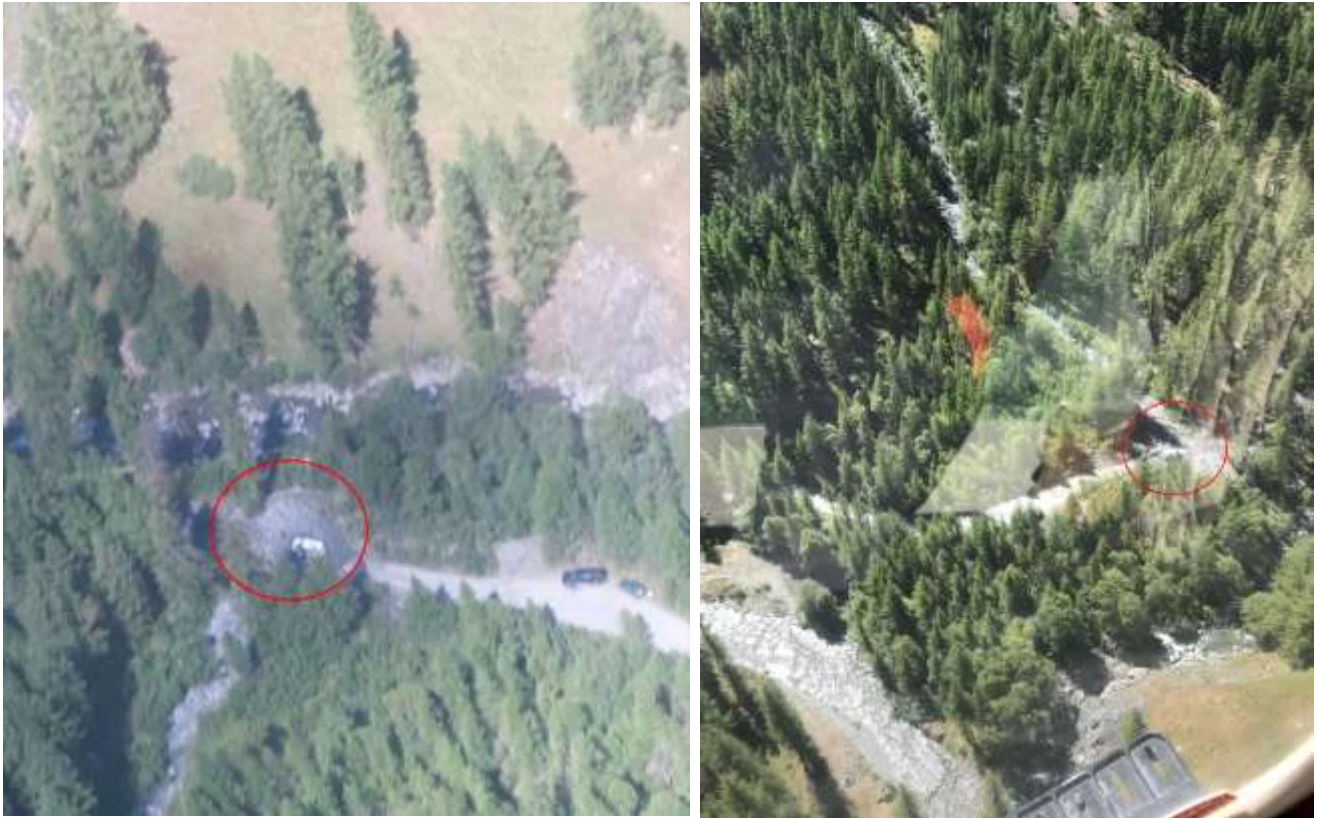
Figura 56 – Più in alta valle, dal versante sinistro della Valle Argentera località Il Caire, si è prodotta una piccola colata che ha invaso la carrozzabile a quota 1870m, posizione indicata con SX15 in Figura 46, determinando l'unico coinvolgimento di un autoveicolo, senza conseguenze per i passeggeri.
