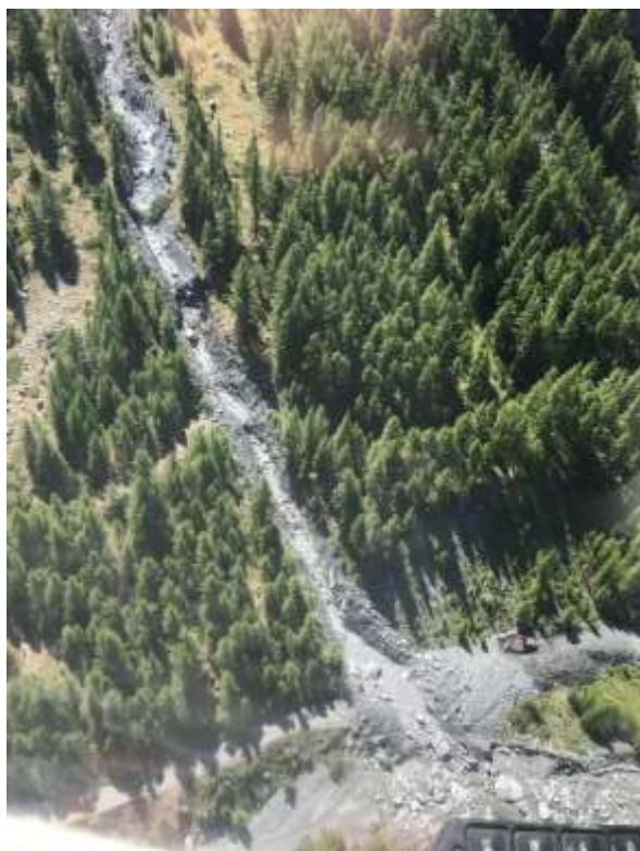
Figura 50 – Incisione che scende dal M. Plaretta, versante sinistro della Valle Argentera (SX5 in Figura 46): sormonto della strada comunale e deposizione di abbondante riporto detritico (a destra, foto CFAVS).
