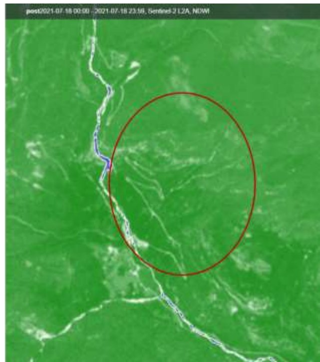
Figura 31 – Confronto immagini di indice NDWI (Normalized Difference Water Index) pre (10/07/2021) e post evento (18/07/2021) con evidenziata l'area del bacino del rio Cugnese; nell'immagine di destra (post evento) è visibile il canale di transito del debris flow (immagini Sentinelhub)
