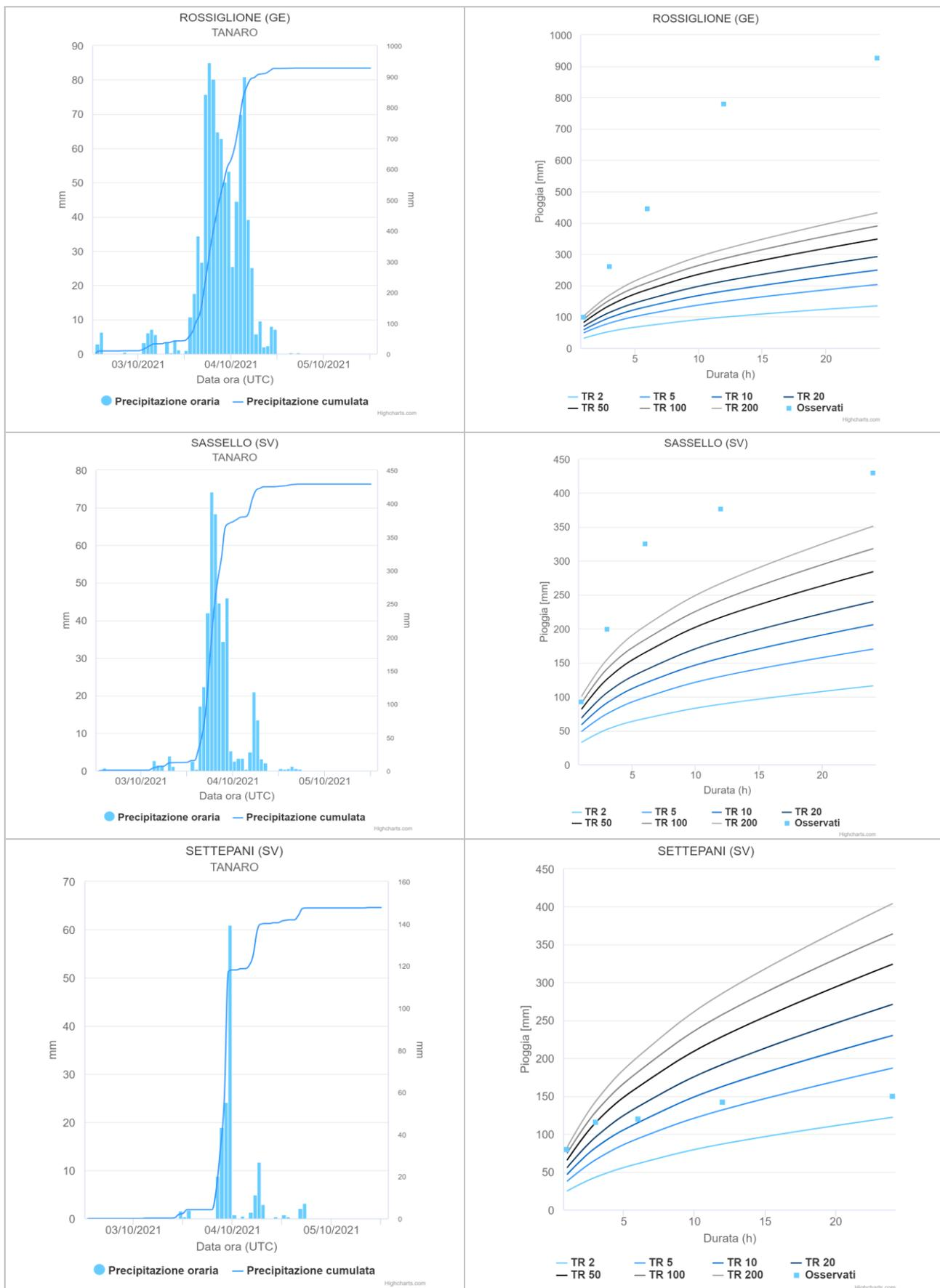
**Figura 17** - Ietogrammi delle stazioni che hanno registrato le precipitazioni maggiori e linee segnalatrici di possibilità pluviometrica per la determinazione del tempo di ritorno del fenomeno.
