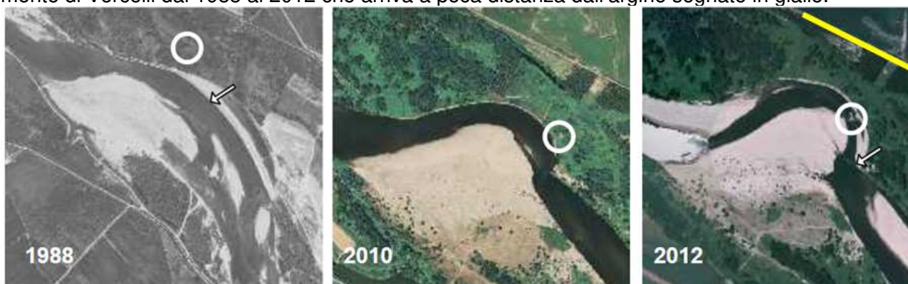
Figura 69 - Erosione della sponda idrografica sinistra nei pressi di Cascina Valgrande. (Ortofoto 1988-89, 2010,2012). Nell'immagine del 1988 si nota la difesa spondale, indicata dalla freccia, mentre nelle successive la forte erosione con aggiramento del traliccio dell'alta tensione (cerchio bianco) e della difesa stessa.
