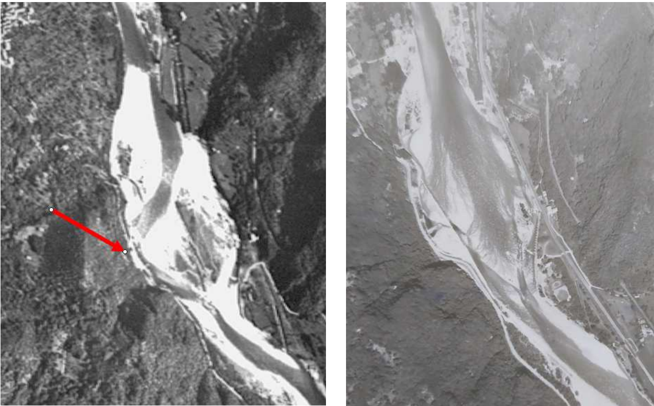
Figura 66 - A sinistra il tratto di corso d'acqua a valle di Crevola nelle foto aeree del 1954, che riportano gli effetti della piena del 1951, la freccia indica una significativa erosione della sponda. In seguito, verrà costruito un argine (ben visibile nella fotografia a destra 1978). Durante la notte tra il 2 e 3 ottobre 2020 l'opera è stata distrutta provocando il cedimento di un tratto di strada di 150 m. Una vettura si trovava a percorrere l'arteria la mattina di venerdì ed è precipitata in alveo. Un uomo ha perso la vita.
