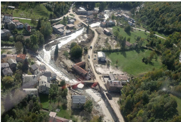
Figura 95 - Pamparato: panoramica da elicottero della parte dell'abitato di Pamparato più coinvolto dall'esondazione del T. Casotto (a sinistra); evidenti segni della violenta attività torrentizia del T. Casotto nell'abitato di Pamparato, in primo piano la strada provinciale sifonata e in secondo piano il ponte romano danneggiato.
