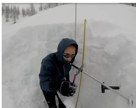
**Figura 3.15:** Esecuzione di un rilievo itinerante: pesata di una carota campione di uno degli strati identificati nel manto nevoso per determinarne la massa volumica
