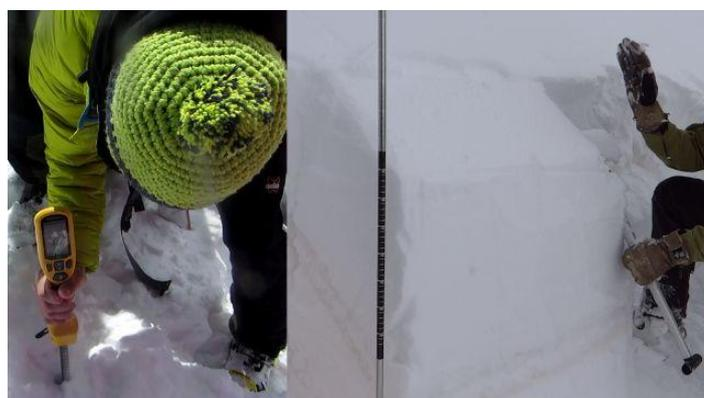
**Figura 3.16:** Utilizzo della sonda SP2 e test di stabilità (extended column test ECT)
