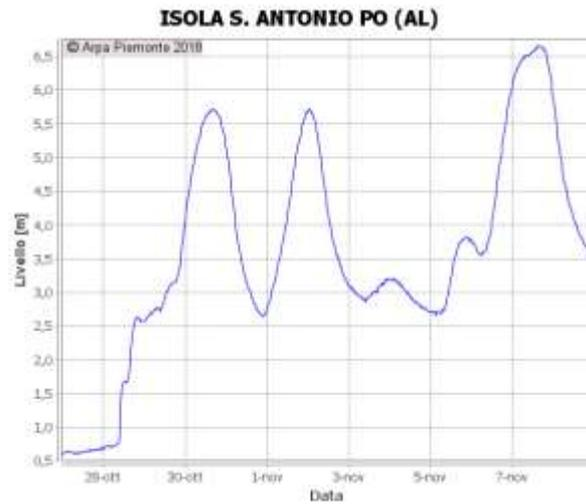
Figura 62. Idrogrammi delle stazioni idrometriche del Po nelle sezioni più significative.
