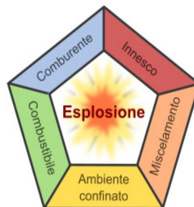
Fig. 1 – Il pentagono delle esplosioni da polveri
