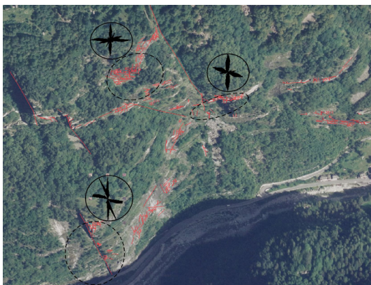
Figura 3 – Sistemi di discontinuità (linee rosse) e diagrammi a rosa dei settori a maggiore densità di fratturazione (cerchi neri tratteggiati). I sistemi di frattura mostrano una direzione media N-S, E-W e WNW-ESE.
