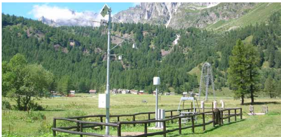
Fig. 2.6 Stazione meteorologica automatica di Alpe Devero; sulla sinistra, in primo piano, è possibile visualizzare il nivometro ad ultrasuoni.
