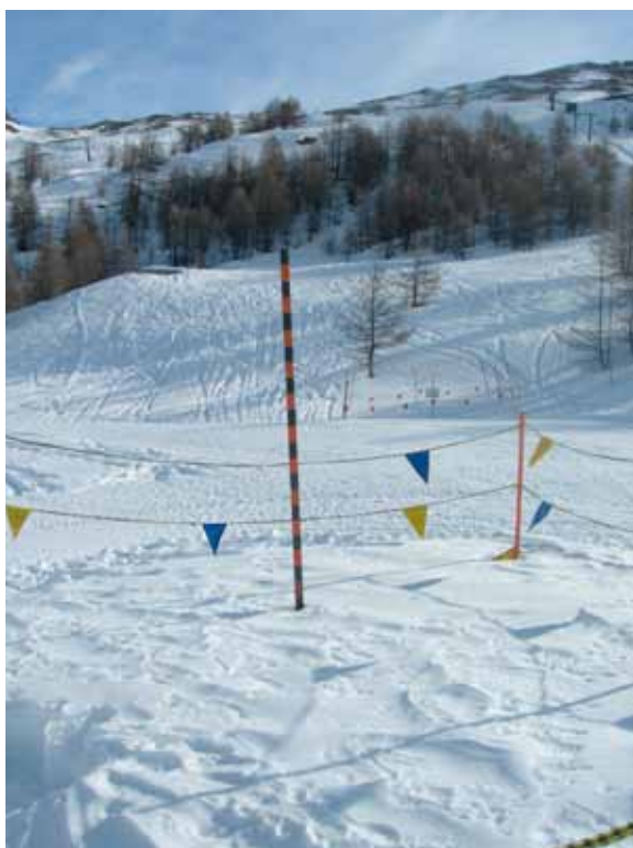
Fig. 2.4 Asta graduata in un campo neve per la misurazione dell'altezza di neve al suolo.
