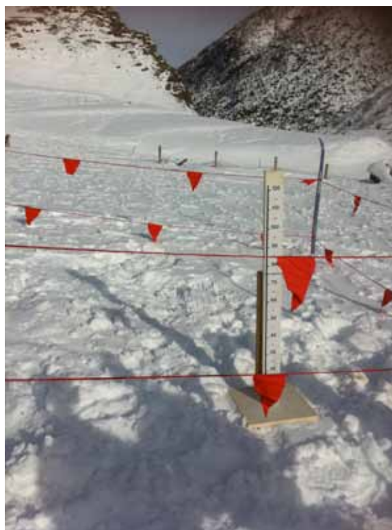
Fig. 2.5 Tavola per misura della neve fresca (HN) con asta graduata.
