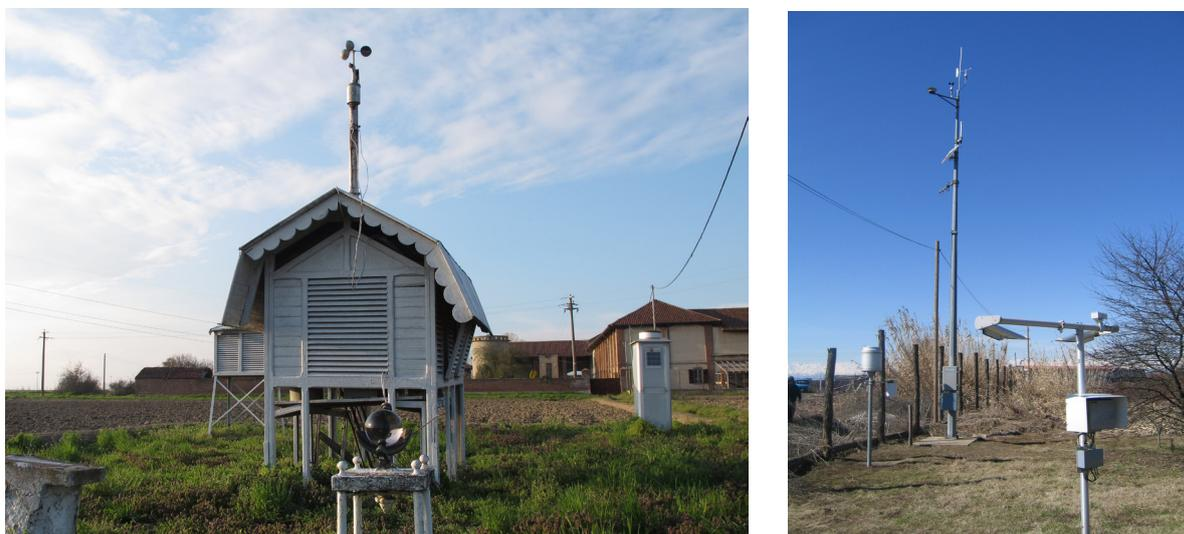
Fig. 4. A sinistra: stazione meteorologica SIMN di Vercelli; a destra: stazione meteorologica ARPA Piemonte di Vercelli.
