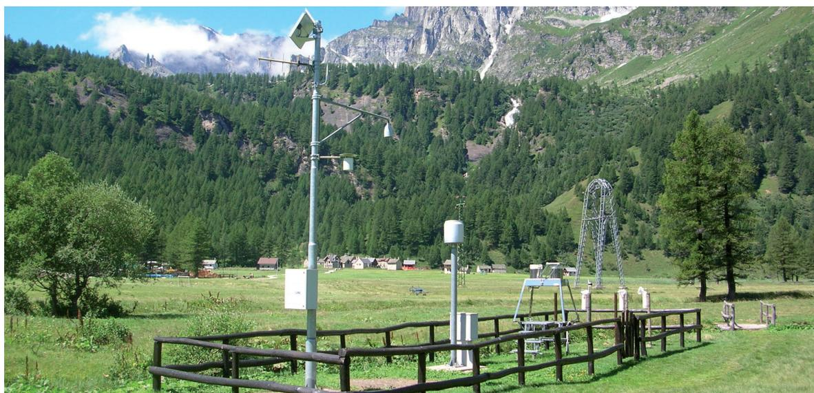
**Fig. 2.6** Stazione meteorologica automatica di Alpe Devero; sulla sinistra, in primo piano, è possibile visualizzare il nivometro ad ultrasuoni.
