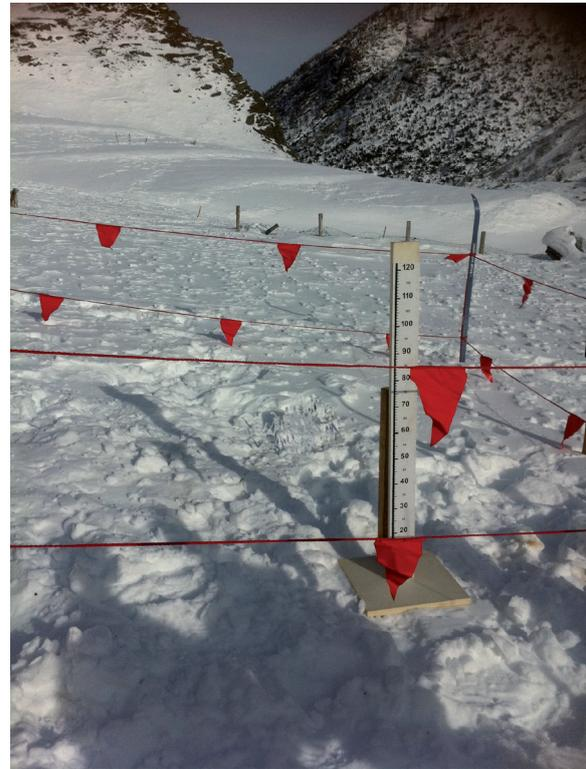
**Fig. 2.5** Tavoletta per misura della neve fresca (HN) con asta graduata.
