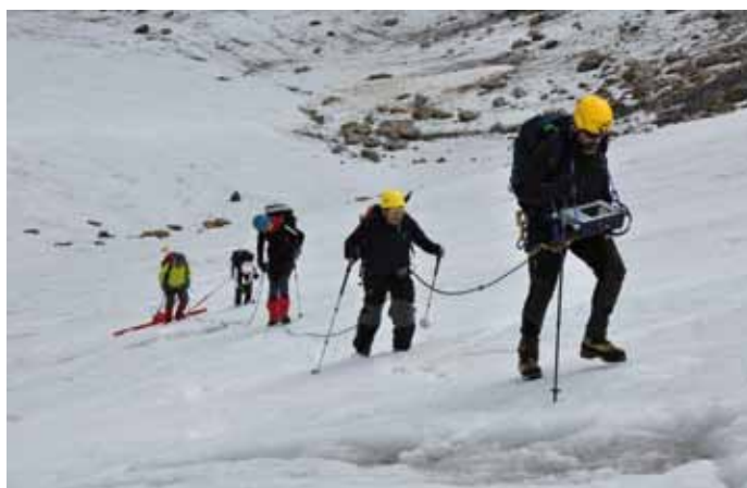
Foto 8 - Rilievi GPR per la misura dello spessore del ghiaccio
