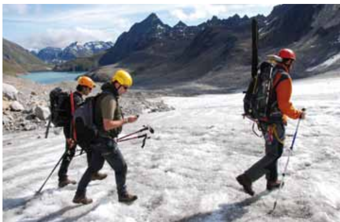
Foto 7 - Un operatore si muove sulla superficie del Ghiacciaio del Sabbione con un ricevitore GPS, che consente il rilievo della traiettoria seguita con precisione centimetrica
