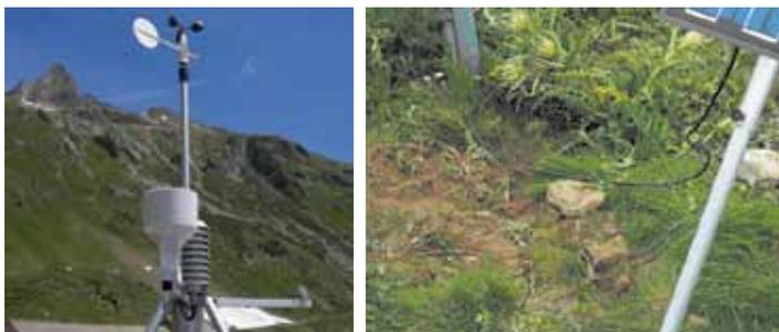
*i sensori di temperatura, radiazione solare, vento, precipitazione, a destra l'area in cui erano interrati i due sensori di temperatura e umidità del suolo.*
