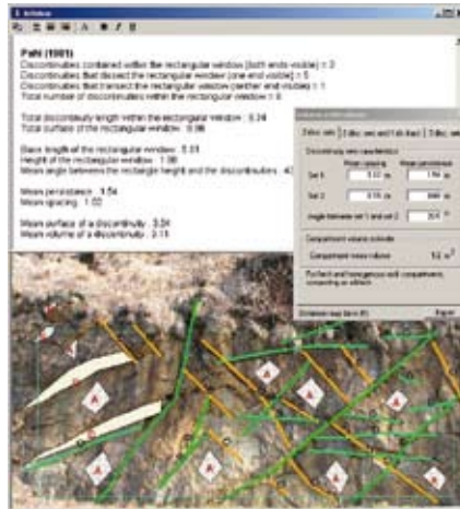
FIG. 4.6 Esempio di elaborazione con il programma Mattercliff per la valutazione quantitativa di spaziatura e persistenza delle discontinuità e della volumetria dei blocchi.
