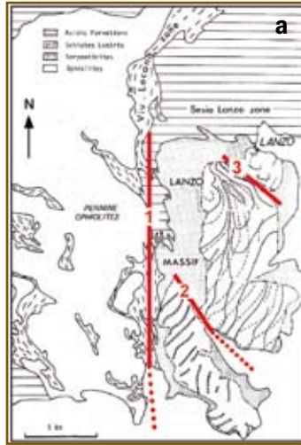
FIG. 2.9 – a) Principali zone di taglio (ZT) che coinvolgono l'area del CUL. 1) ZT Viù-Locana, 2) ZT di Valdellatorre, 3) ZT di Vallo-Germagnano (Boudier, 1978, modificato); b) strutture S-C legate alla ZT Viù-Locana (loc. Porte di Viù).
