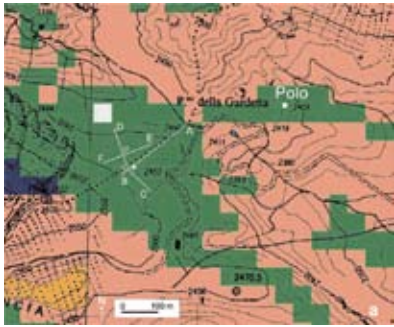
FIG. F – a) Localizzazione degli stendimenti geoelettrici (linee bianche) presso il Passo della Gardetta (Valle Maira, CN); b) esempio di risultato della elaborazione tomografica lungo il profilo C-D.
