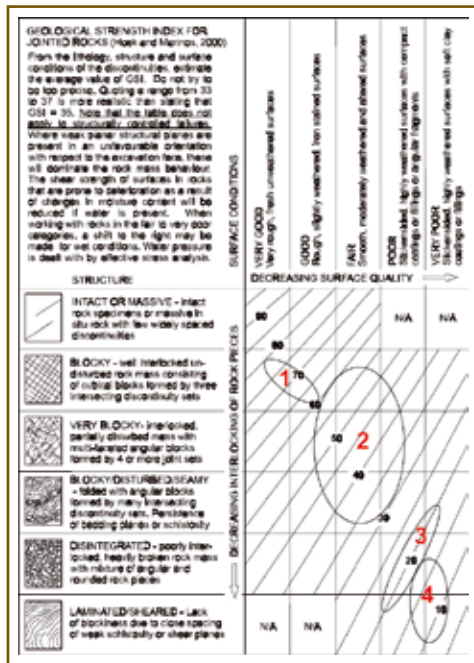
FIG. 4.8 – Valutazione del GSI (Marinos et al., 2005) nell'area di studio. 1) Cluster di dati relativi ad ammassi rocciosi "blocky" con discontinuità caratterizzate da buone qualità geomeccaniche; 2) cluster di dati relativi ad ammassi rocciosi da "blocky" a "disturbed" con discontinuità caratterizzate da caratteristiche geomeccaniche da buone a deboli; 3) cluster di dati relativi ad ammassi rocciosi da "disturbed" a "laminated" con discontinuità caratterizzate da caratteristiche geomeccaniche da deboli a pessime; 4) cluster di dati relativi ad ammassi rocciosi da "disintegrated" a "laminated" con discontinuità caratterizzate da caratteristiche geomeccaniche da deboli a pessime.
