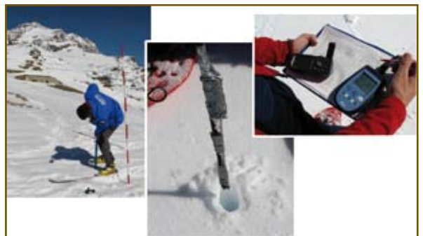
FIG. D - Fasi delle misurazioni BTS al sito del Passo dei Salati (q. 2990 m slm circa, Alagna Valsesia, VC). Da sinistra verso destra: fase di preparazione del foro di misura, inserimento del sensore termico nel foro di misura, ubicazione con GPS del punto di misura e rilevazione della temperatura BTS.
