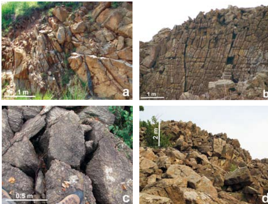
FIG. 4.9 Esempi dei diversi gradi di allentamento di ammassi rocciosi del CUL: a) fratturato, b) allentato, c) molto allentato, d) disarticolato (la linea tratteggiata separa il substrato, nella parte superiore, dall'accumulo detritico, nella parte inferiore). Dettagli nel testo.
