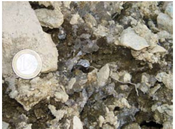
FIG. 5.17 – Criosollevarimento di particelle pluricentriche di terreno ad opera di cristalli di ghiaccio lunghi 3÷4 cm circa (versante settentrionale del M. Arpone, (25 marzo 2008).
