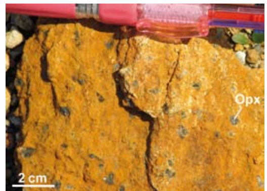
FIG. 4.11 - Campione di peridotite alterata ricoperta completamente da un feltro argilloso da cui emergono i cristalli inalterati di ortopirosseno (Opx).
