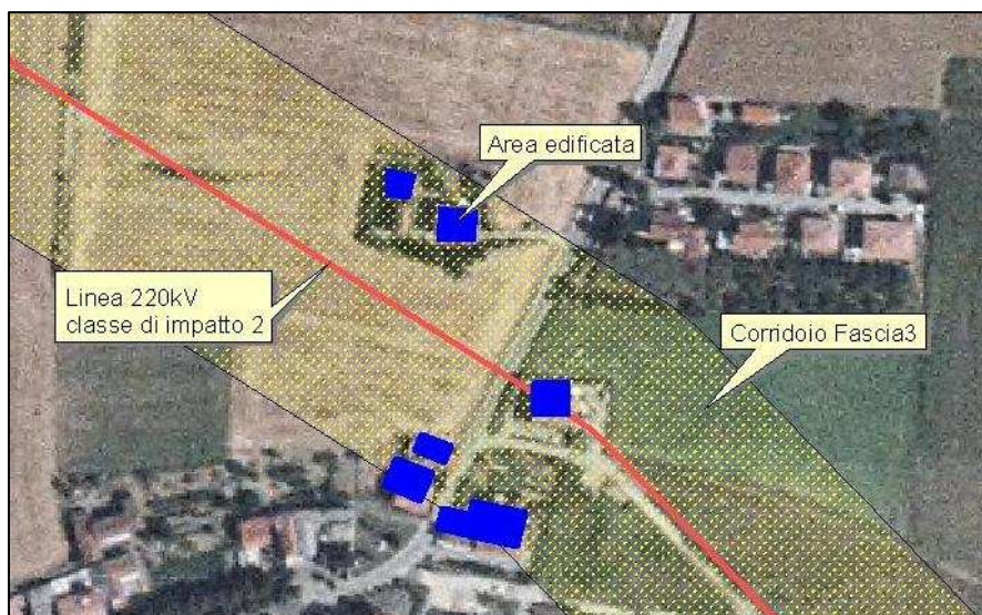
Fig. 3.2.7- Esempio di classificazione di una linea a 220kV con indicazione di C I , A E e A F
