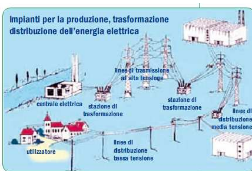
Fig. 2.2 – Rete di trasmissione e distribuzione dell'energia elettrica [4]
