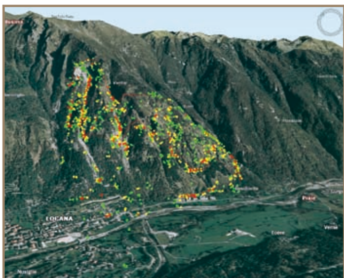
Figura 2.5.5 Esempio di output ottenuto da un'elaborazione di ROTOMAP GIS® e rielaborato con Skyline. Distribuzione dei punti di arresto dei massi. In giallo e in rosso le celle dove si è fermato il numero maggiore di massi
