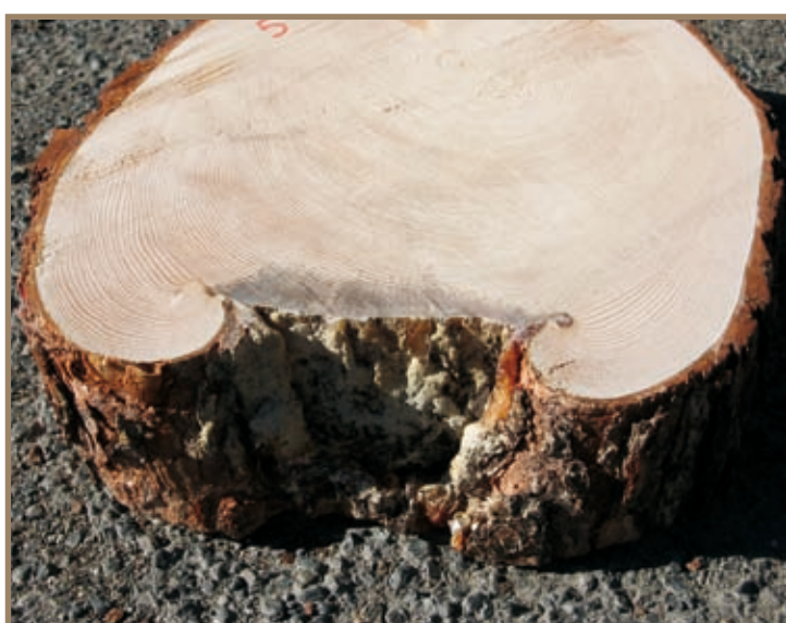
Campione n. 5 Dettaglio della conformazione della ferita e del rilevante tasso di accrescimento del callo cicatrizziale rispetto alle sezioni non interessata dall'urto
