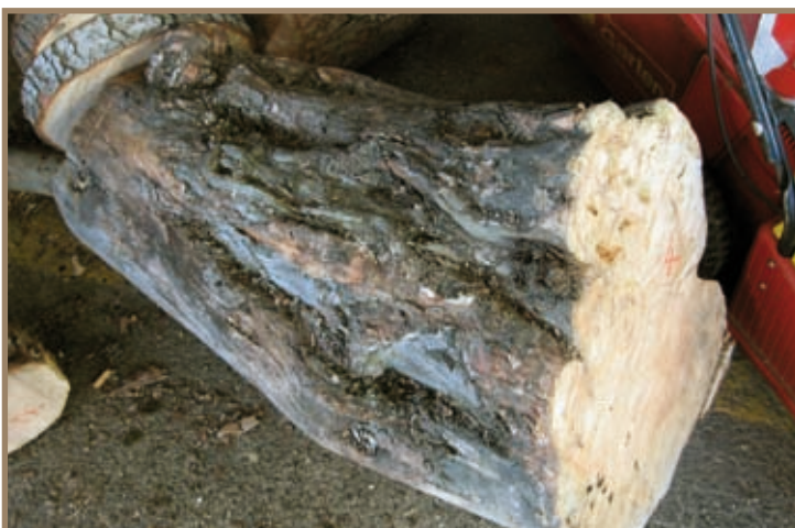
Campione n. 4 Dettaglio dell'assenza di cambio in prossimità degli urti
