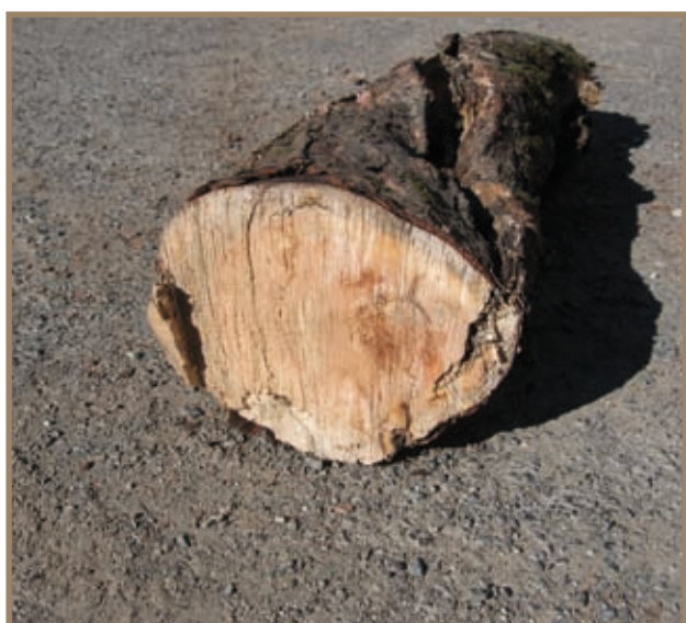
Campione n. 6 Ferita limitata sulla sezione trasversale, ma importante longitudinalmente
