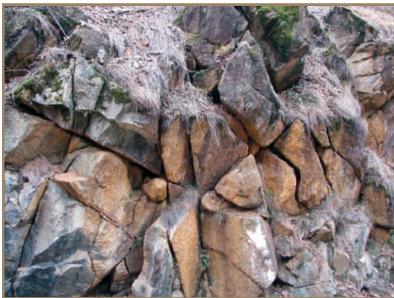
Figura 2.7.32 Tipico aspetto frantumato e allentato degli ammassi rocciosi peridotitici nella bassa valle di Viù
