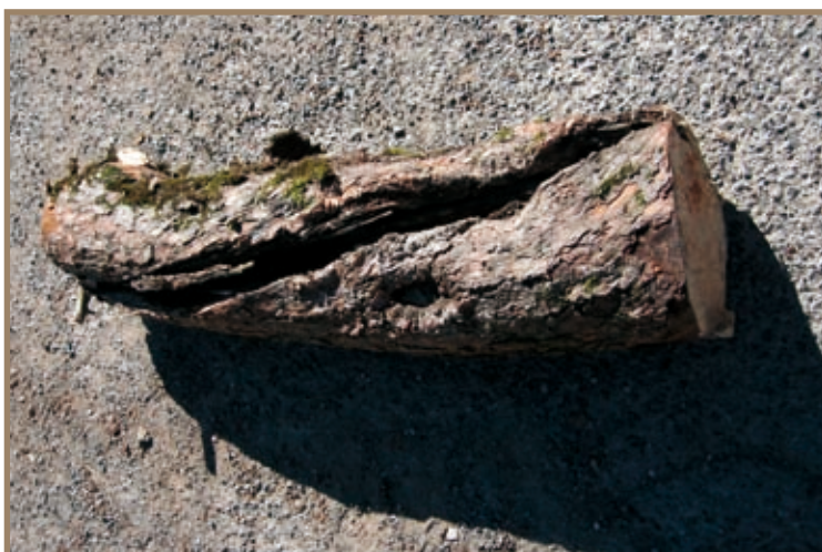
Campione n. 6 Urto su pino uncinato di piccole dimensioni che ha causato la sfibratura dell'intero fusto, senza peraltro sradicare, troncare o portare a morte la pianta
