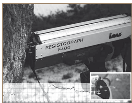
Figure 3.3.132 Unité de forage du résistographe "IML Resi F400"
