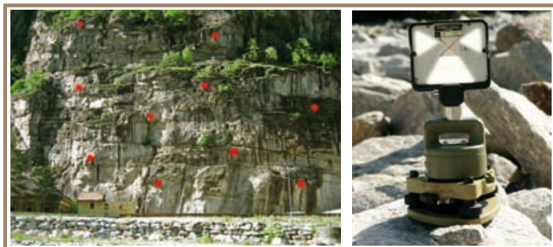
Figura 2.9.5 Posizionamento delle mire sulla parete (a) e riflettore da terra (b)
