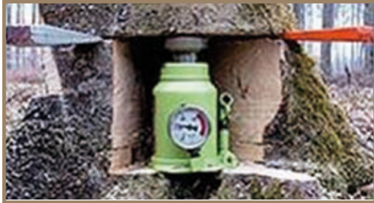
Figure 3.3.93 Exemple de logement pour un cric hydraulique (Photo Jirikowski, W. 2006)
