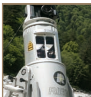
Figura 2.9.6 Sistema laser scanner-fotocamera digitale ad alta risoluzione
