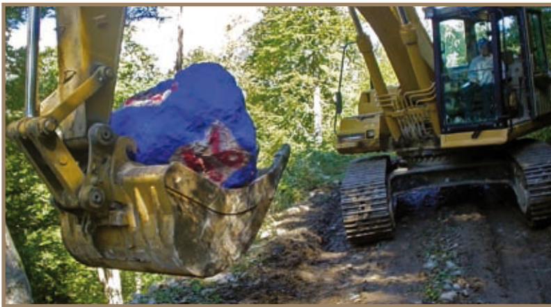
Figure 3.3.28 Photo de lâcher d'un bloc de 1m 3 sur le site expérimental de Vaujany
