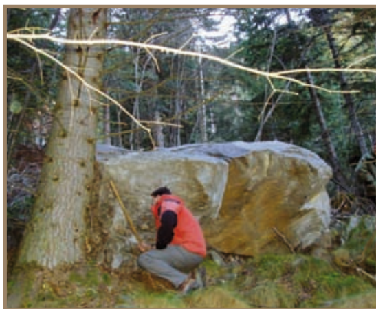
Figure 3.3.27 Bloc de 9 m 3 arrêté par un épicéa
