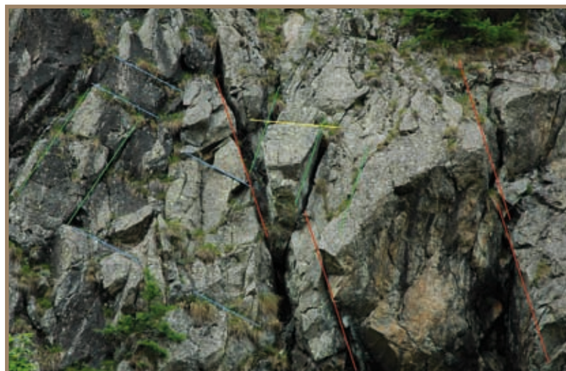
Figura 2.7.14 Esempio di parete aggettante sulla strada (area omogenea n° 20) in cui sono evidenziati alcuni dei piani di discontinuità rilevati
