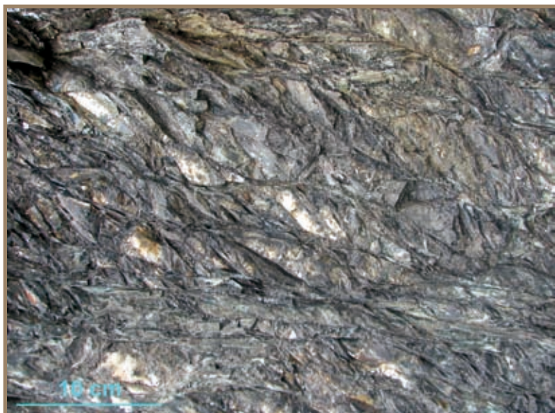
Figura 2.7.34 Serpentiniti tettonizzate con fratturazione pervasiva, tipica delle zone di taglio principali, affioranti in località Porte di Viù
