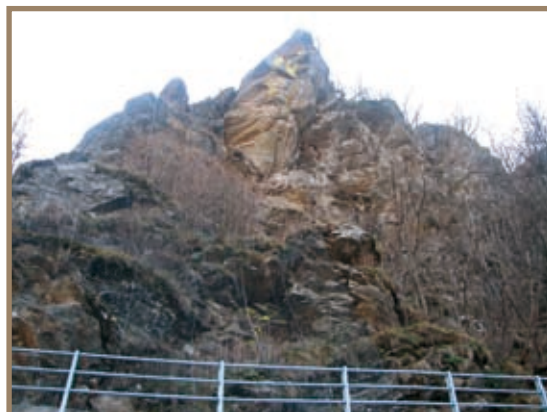
Figura 2.7.56 Ammasso roccioso con fratturazione irregolare. In alcuni casi, a causa dell'eccessiva variabilità della fratturazione, non è stato possibile identificare famiglie di giunti con caratteristiche accomunabili
