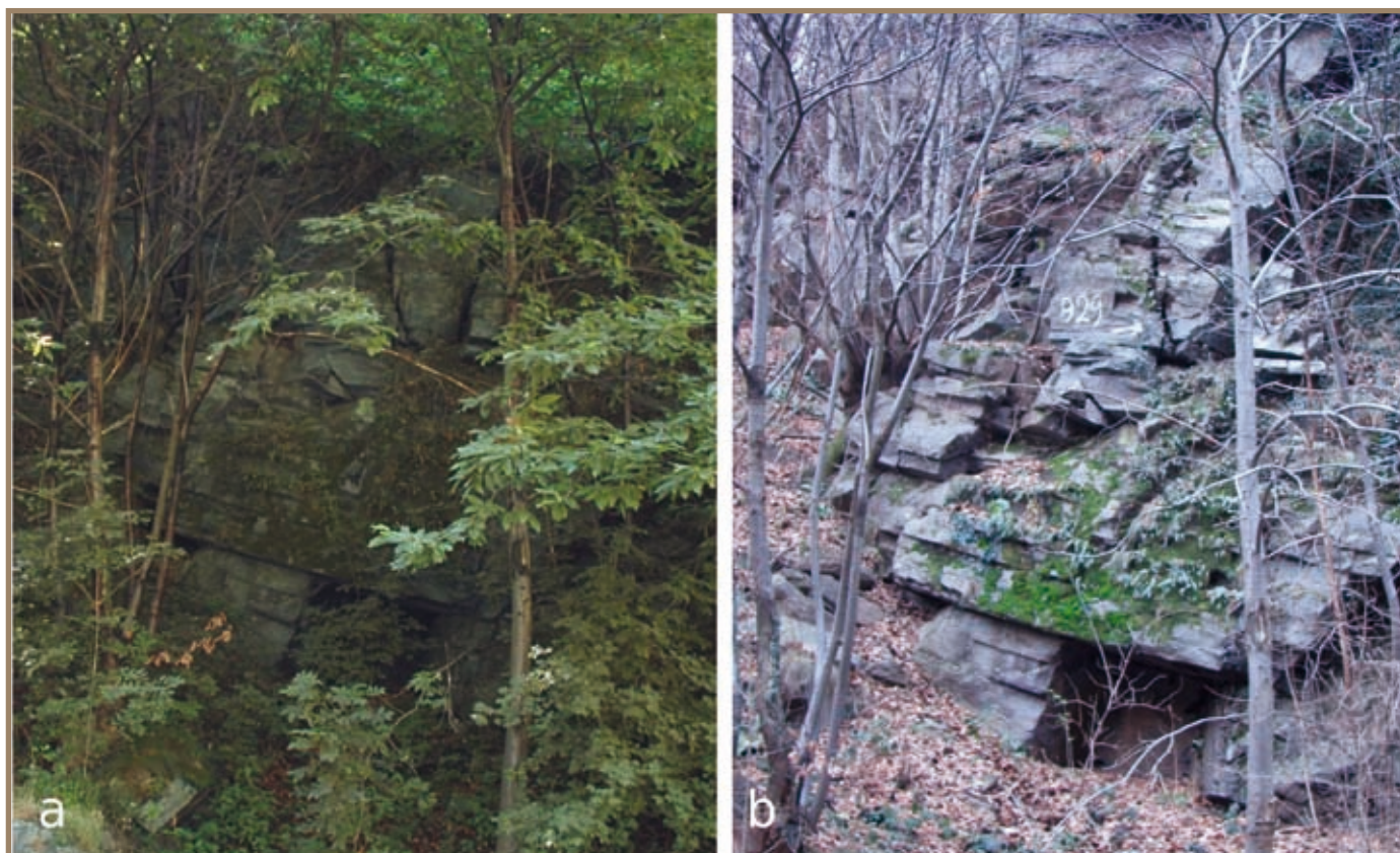
Figura 2.7.54 Confronto tra rilievo estivo ed invernale in zone vegetate. a) foto del luglio 2006; b) foto del gennaio 2007. Nella stessa area è presente un fenomeno di ribaltamento di dimensioni rilevanti, che durante la prima analisi (avvenuta in periodo estivo) non era stato identificato, perché dalla strada provinciale risultava completamente coperto dalla fitta vegetazione. Il fenomeno è posto una trentina di metri più a monte rispetto al livello della strada provinciale
