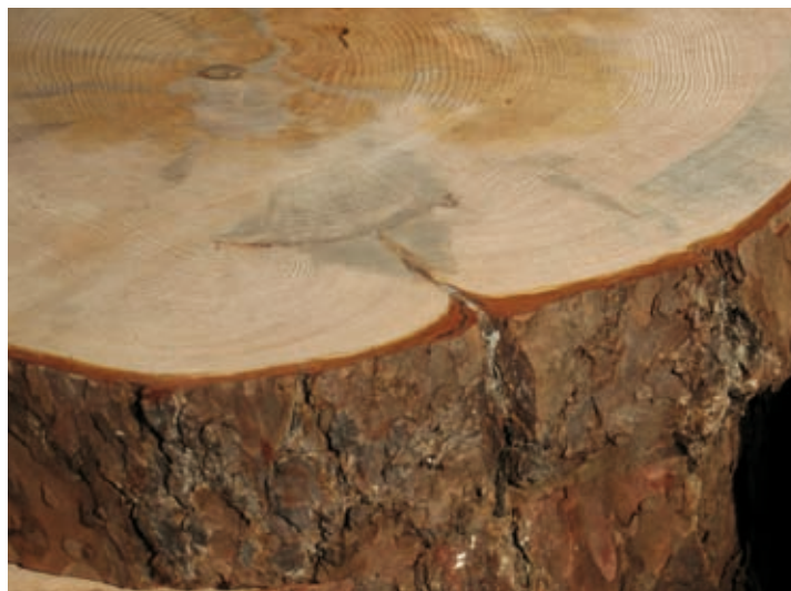
Campione n. 3 Dettaglio del callo cicatriziale in sezione e su corteccia
