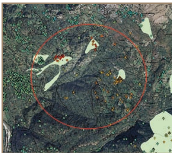
Figura 2.10.5 Carema (TO): l'inventario IFFI ha individuato alcuni fenomeni rapidi e di limitate proporzioni, principalmente crolli in roccia e colamenti superficiali; l'analisi PSInSAR™ ha messo in evidenza probabili movimenti più profondi non ancora conosciuti
