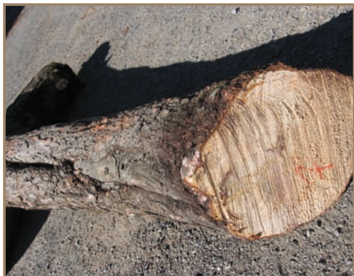
Campione n. 7 Ferita di piccole dimensioni in sezione trasversale, ma estesa lungo il fusto, buona cicatrizzazione
