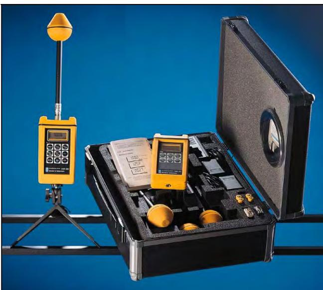
Fig. 5.1 - Misuratore di campo elettrico EMR 300
