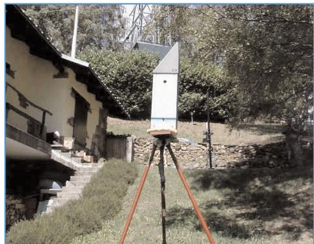
Fig. 30 Sistema di monitoraggio in continua (centralina) per la misure del campo elettromagnetico a radiofrequenza.
