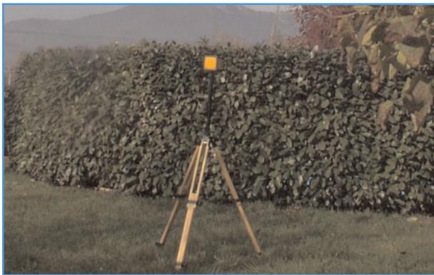
Fig. 27 Misura del campo elettrico in prossimità di un elettrodotto.
