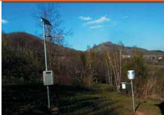
sono collegate attraverso ponti radio e forniscono informazioni dettagliate sulle condizioni meteorologiche in tempo reale al Centro Funzionale Piemontese, dove i dati vengono acquisiti e validati costituendo la Banca Dati Meteorologica e Climatologica, un archivio informativo di misure composto da più di 85 milioni di osservazioni. La Figura 2.2.3 mostra una stazione meteorologica automatica.
