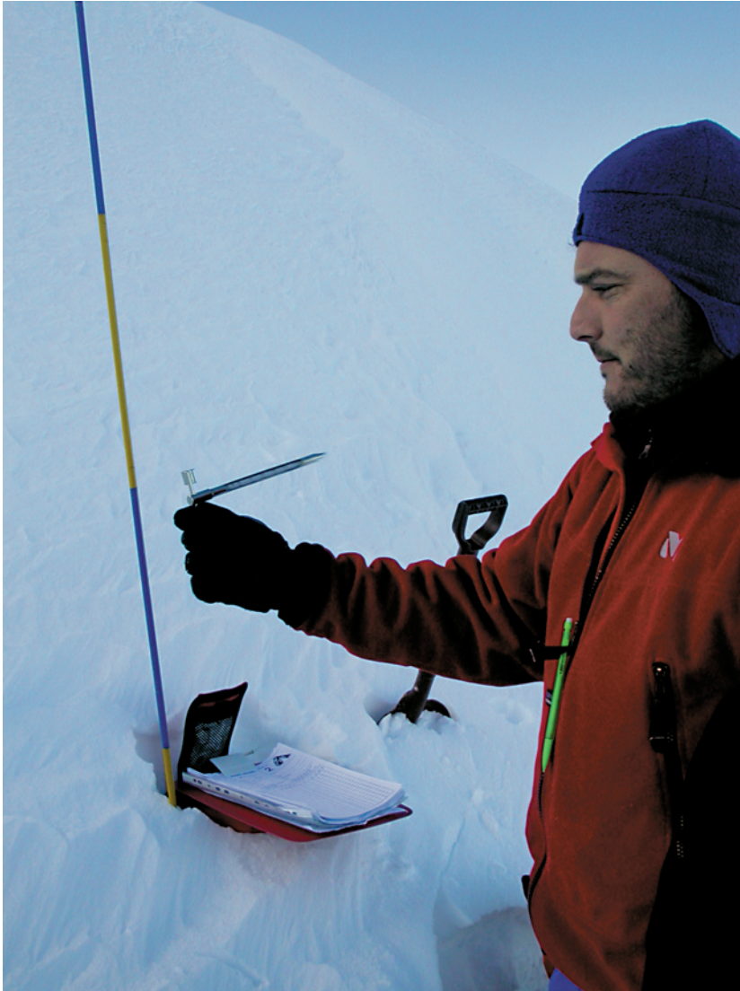
Figura 2.6.11 Effettuazione di rilevamenti nivo-meteorologici per la previsione locale del pericolo di valanghe
