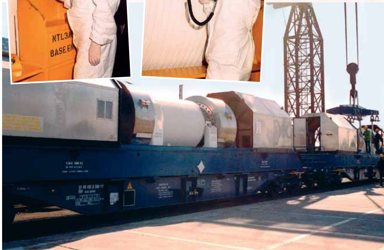
Operazione di movimentazione dei casks presso il punto di trasferimento di Vercelli
