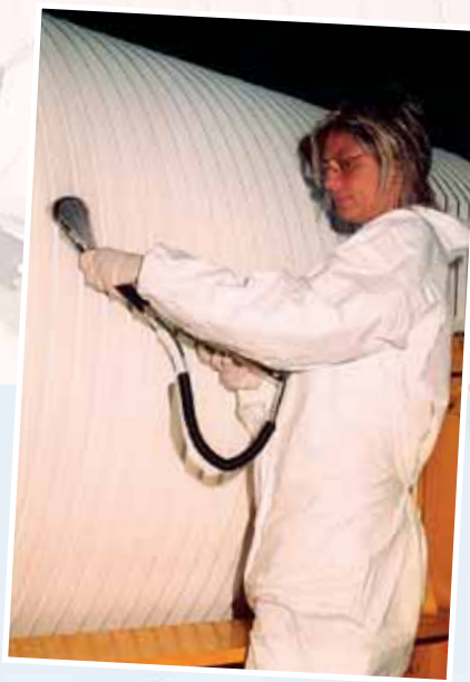
foto a sinistra - Effettuazione di smear test per la valutazione della contaminazione trasferibile
