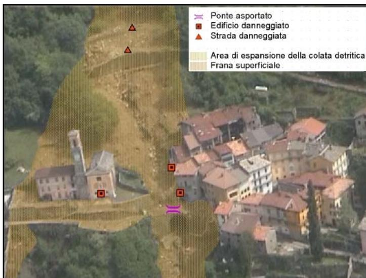
**Fig.18.** Comune di Campiglia Cervo, frazione Valmosca: la foto aerea mostra l'area interessata dal processo di trasporto solido. La chiesa e due abitazioni sono state gravemente danneggiate.
