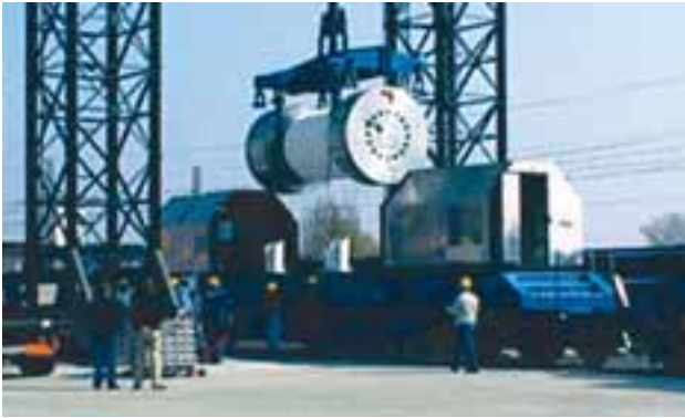
Operazioni di movimentazione del cask presso il punto di trasferimento multimodale di Vercelli
