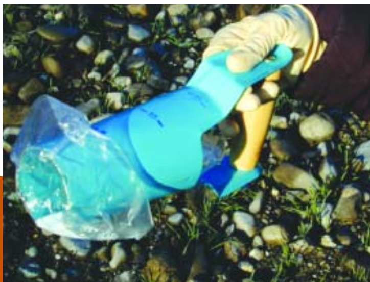
Fig. 15A - Preparazione del carotatore ed estrazione del campione di suolo
