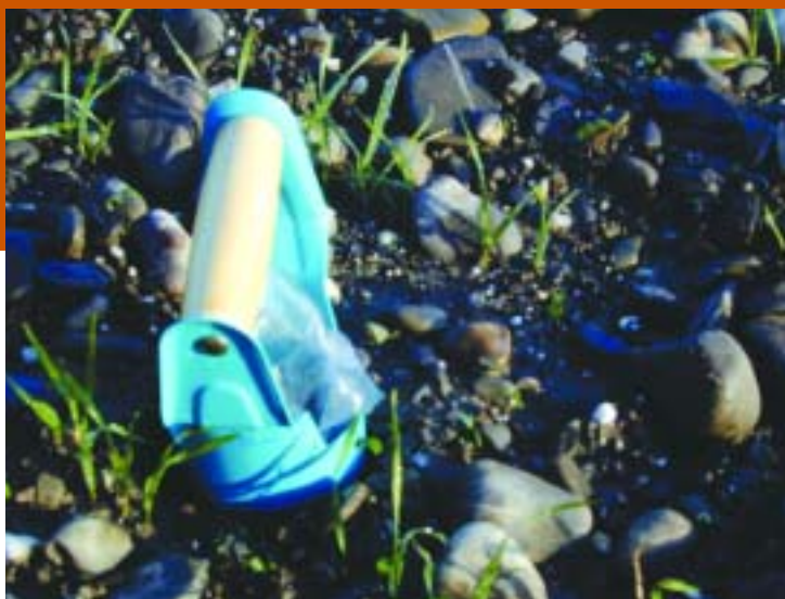
Fig. 15B - Preparazione del carotatore ed estrazione del campione di suolo
