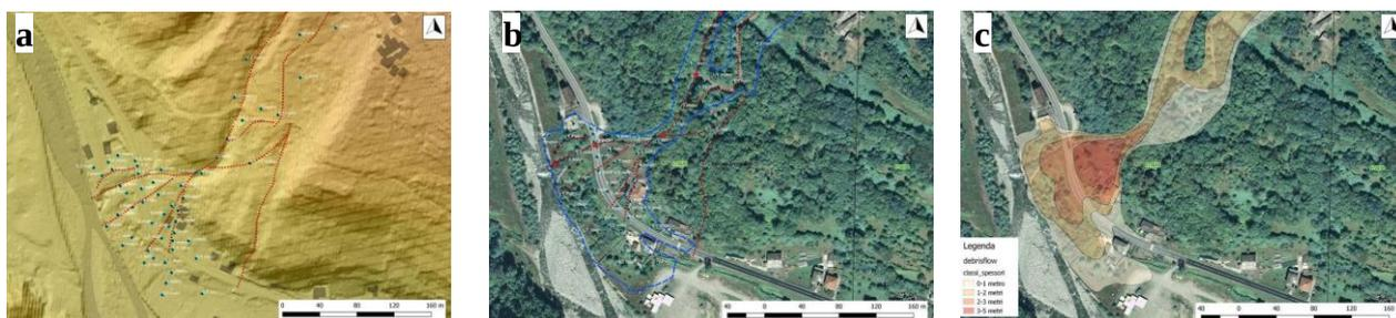
Figura 12. Stima del volume di detrito depositatosi sul fondovalle. Analisi e confronto con DTM LiDAR, risoluzione a terra 1 metro - Regione Piemonte (a) rilievi da terreno di canali riattivati di deflusso, sezioni e spessore dei depositi (b), mappa della stima dei volumi (c)
