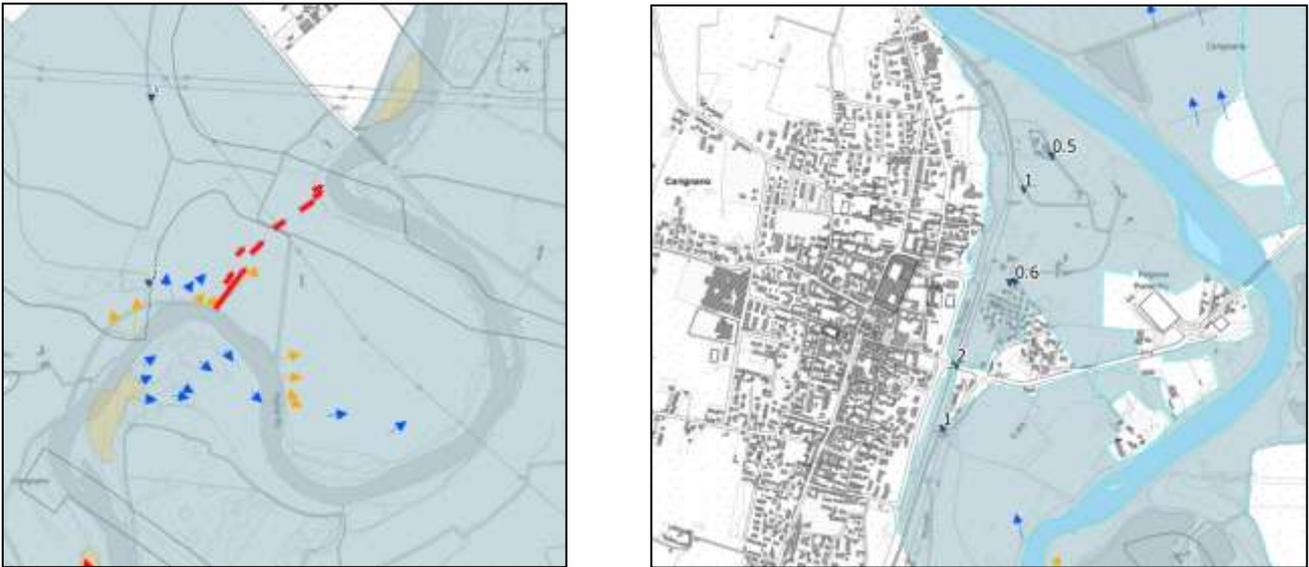
Figura 9. Nella cartografia a sinistra il taglio del meandro, evidenziato dalle frecce rosse, naturale evoluzione dei corsi d'acqua ad alveotipo meandriforme. A destra le aree inondate a Carignano e i battenti idrici raggiunti
