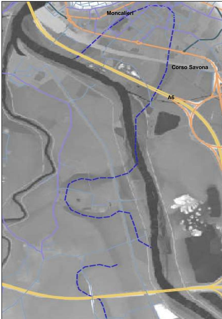
Figura 11. Zona a monte di Moncalieri - forme di meandri relitti (linea tratteggiata blu) presenti sulla pianura alluvionale in sinistra e in destra rispetto all'alveo attuale derivati dal DTM derivati da lidar
