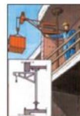
installazione di argano a bandiera tramite puntello
