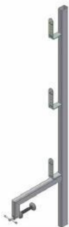
Parapetto provvisorio ammorsato con ganascia fissa
