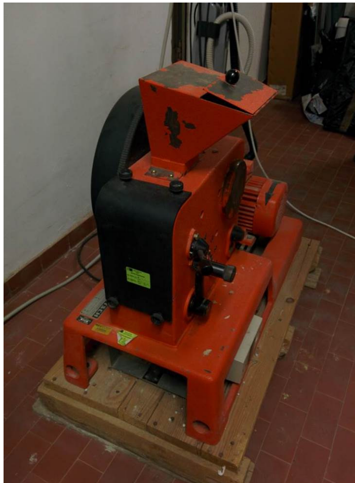
Figura 4: mulino a ganasce da collocare nella cappa da terra
