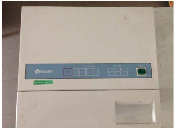
Gli omogeneizzatori da laboratorio Stomacher® consentono di miscelare e omogeneizzare un'ampia gamma di campioni da laboratorio in modo veloce e affidabile. Le macchine Stomacher® funzionano grazie all'azione esercitata da due palette con moto alternato su un campione racchiuso in un sacchetto di plastica sterile.
