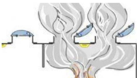
Sul tetto di copertura di alcuni ambienti *Teatro della Concordia* sono installati degli E.N.F.C. Evacuatori Naturali di Fumo e Calore della COADURO.
