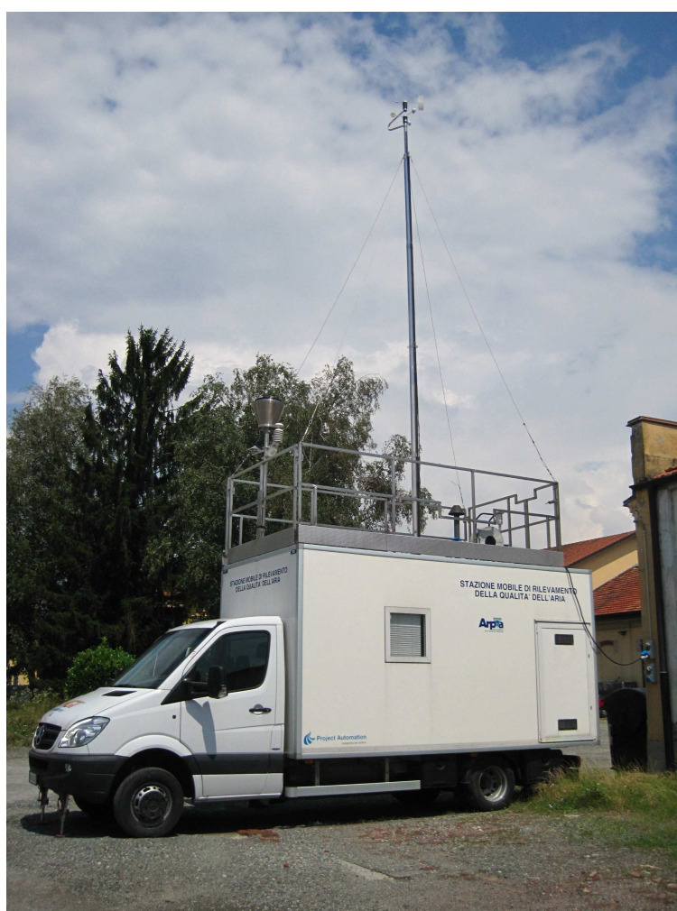
FIGURA 43: la stazione mobile di rilevamento della qualità dell'aria.
