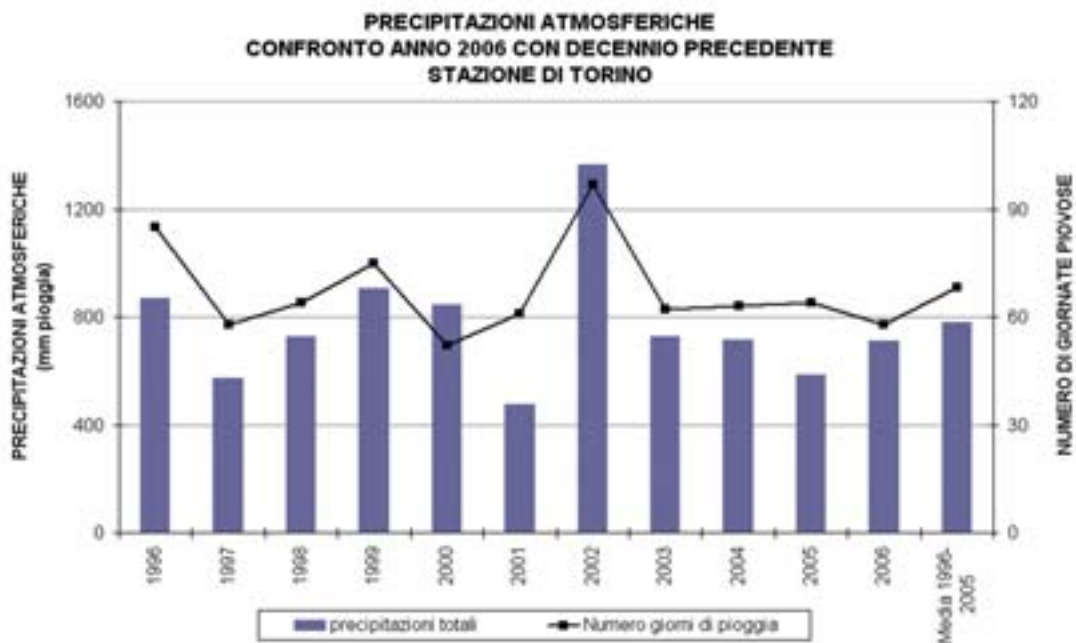
FIGURA 22: precipitazioni atmosferiche: sommatorie annuali e media del decennio in termini di quantità di precipitazioni e di numero di giornate piovose per la stazione di Torino.
