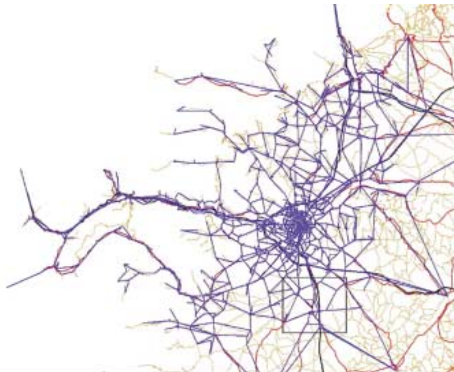
FIGURA 76: sovrapposizione degli archi virtuali (in blu) alle strade presenti nell'area in esame (in rosso).
