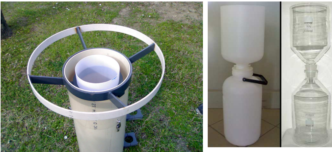
Figura 3: Deposimetro di tipo “bulk” in Polietilene e vetro Pyrex
