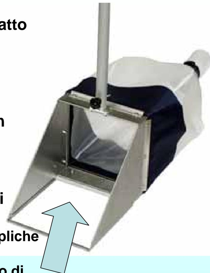
dimensioni dell'intelaiatura 0,32x0,32m ed area di campionamento pari a ca 0,1m<sup>2</sup>
