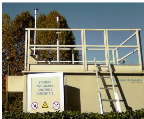
Figura 31) Centralina di Cuneo. Sono visibili le due teste di prelievo per PM_{10} .
