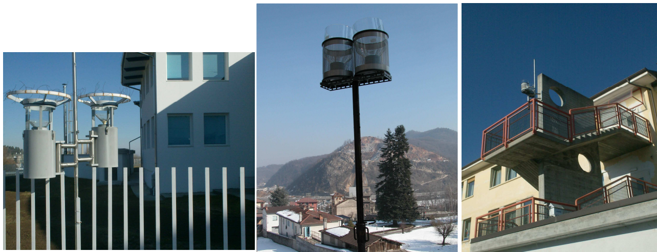
Figura 3) Fotografie dei campionatori di deposizioni nei tre siti di Roccavione scuole, Roccavione Casa Auxilium e Robilante scuole.
