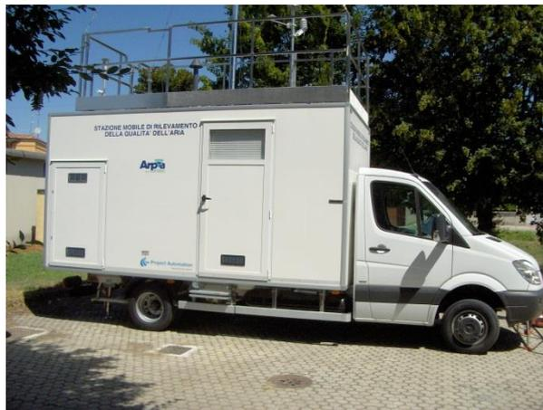
Figura 4-Laboratorio mobile in servizio presso ARPA
