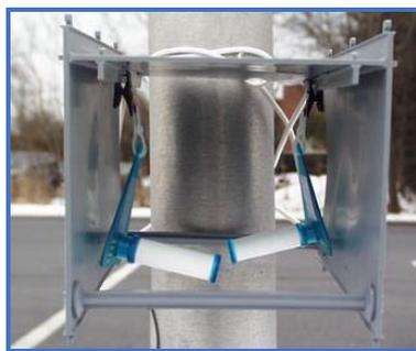
Per esporre i campionatori all'esterno, nel caso in cui non sia presente una copertura che protegga il dispositivo da eventi accidentali e/o atmosferici viene utilizzato un box in polipropilene che assicura il miglior compromesso fra efficienza di riparo e ventilazione.
