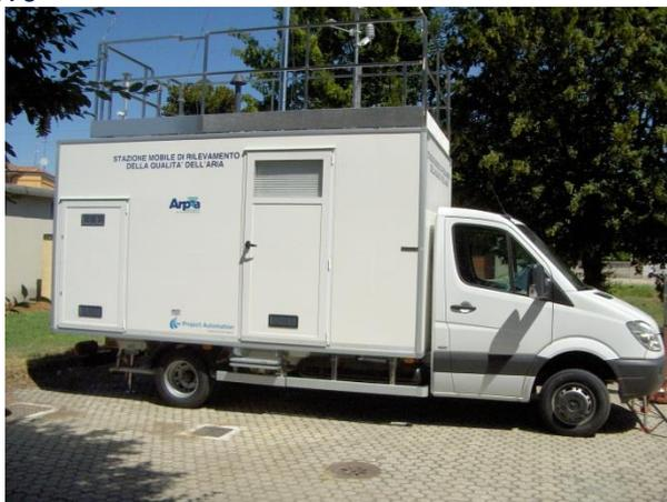
**FIGURA 1-Laboratorio mobile in servizio presso ARPA**
