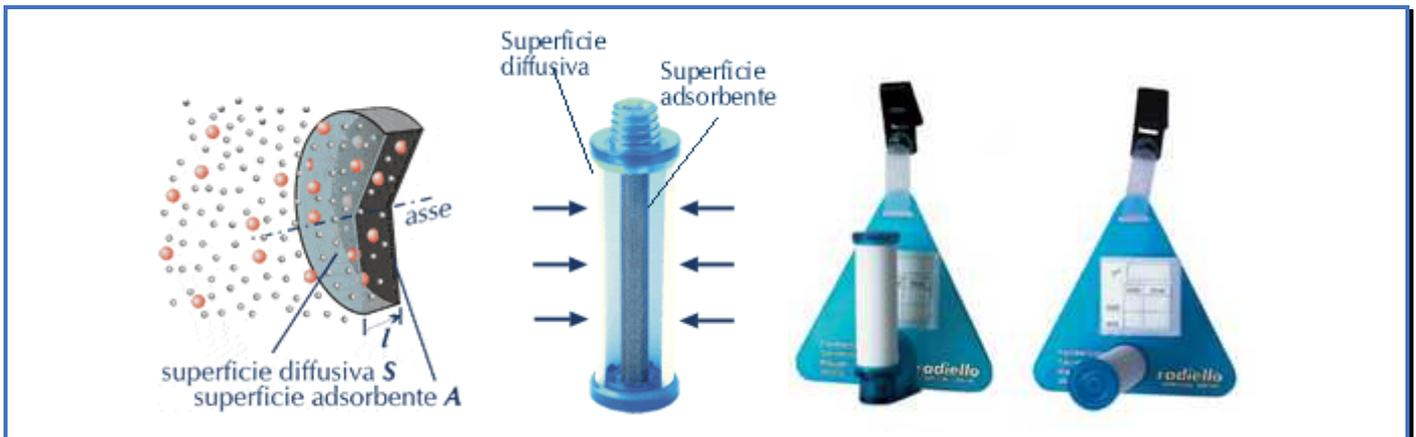
I campionatori passivi utilizzati per effettuare campagne di monitoraggio ambientale periodiche vengono scelti come miglior metodo per via sia della facilità di posizionamento e ritiro (anche in molti punti) sia del basso costo dei materiali e dall'assenza di manutenzione e di necessità di alimentazione elettrica.
