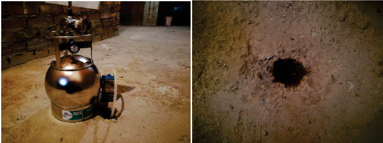
Foto apparato di campionamento e foro di inserzione sul pavimento
