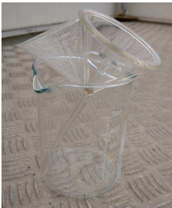
contenitore di raccolta delle acque di condensa atmosferica
