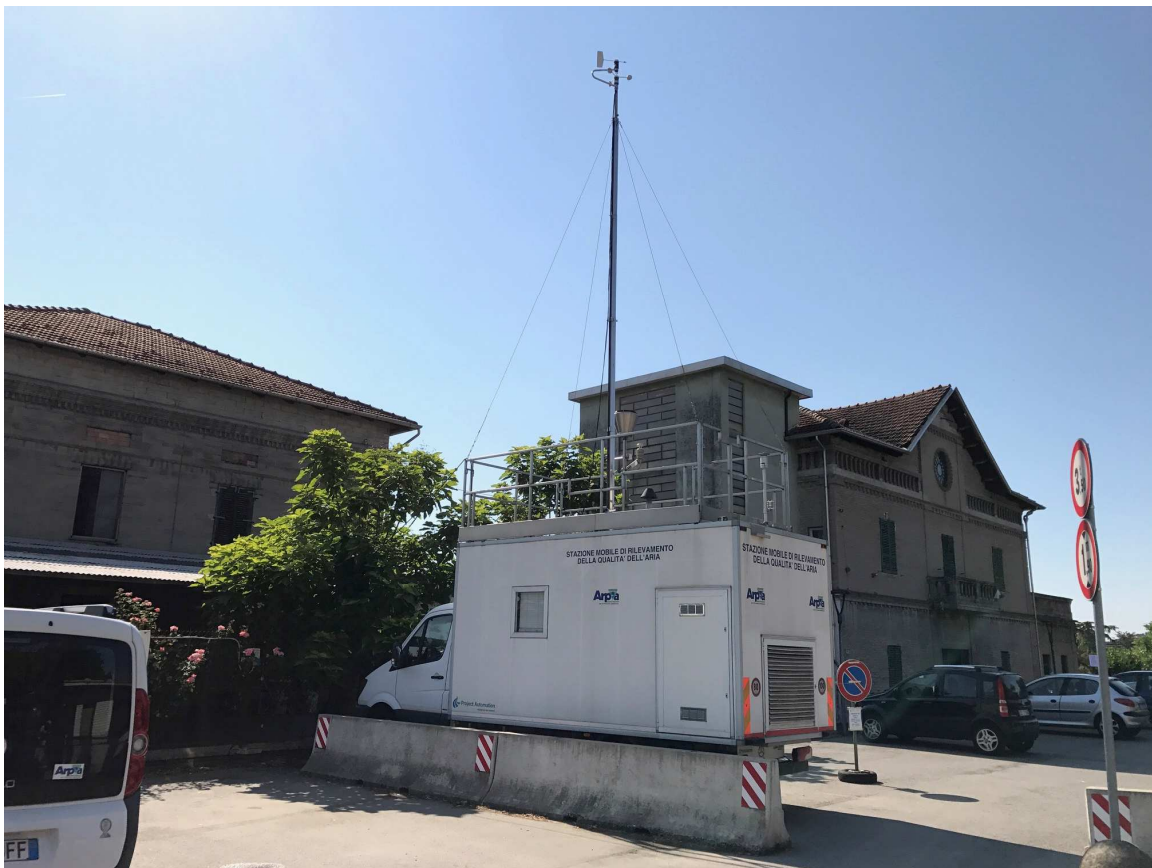
Immagine 3-postazione mobile per monitoraggio qualità dell'aria in p.za Olivazzi
