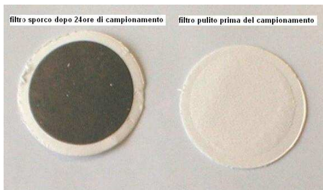
Confronto tra un filtro "pulito" prima del campionamento e "sporco" dopo 24ore di campionamento
