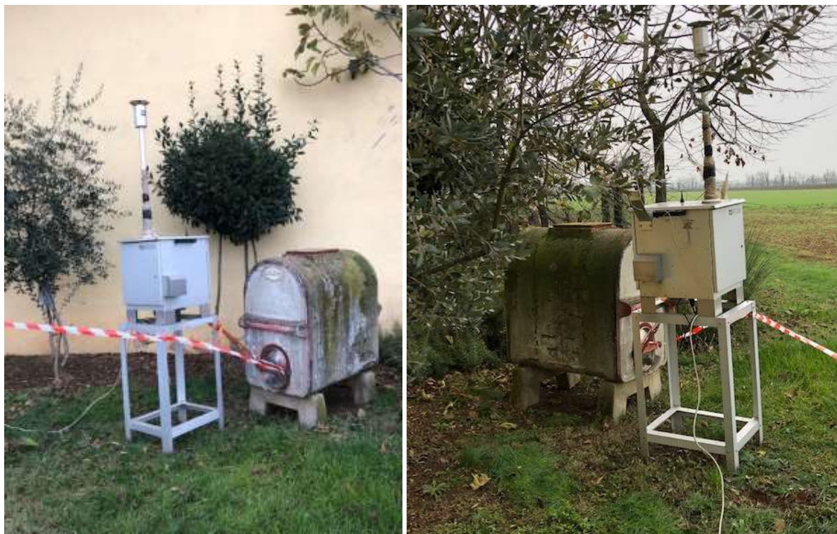
Foto del trasportabile per analisi polveri PM10 presso abitazione privata per Tortona 20, Pozzolo F.ro
