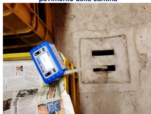
Campionamento con canister in foro sul pavimento della cantina
