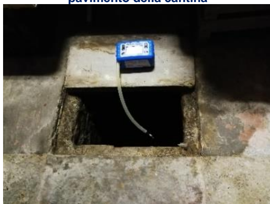
Campionamento con fiala in foro sul pavimento della cantina
