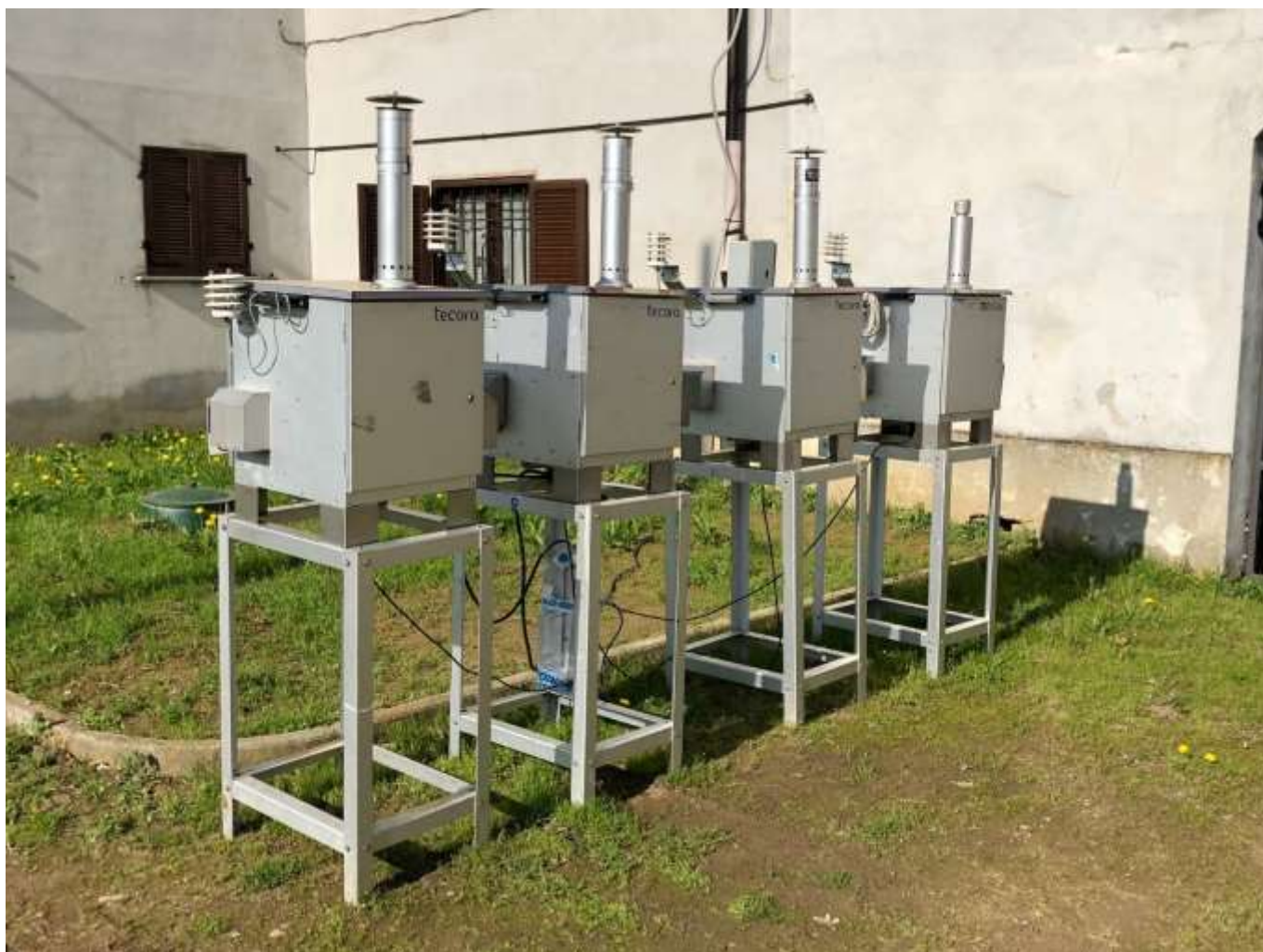
Immagine n°3 : Posizionamento dei campionatori gravimetrico SKYpost PM10/2.5 Arpa e COCIV presso C.na Guarasca
