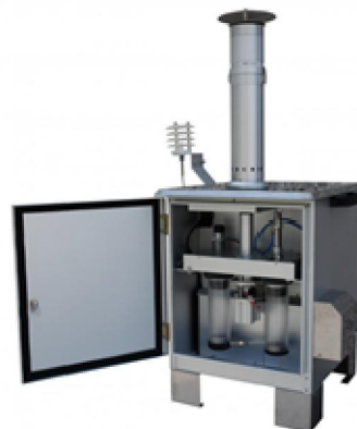
Punti di misura PM10 e immagine campionatore trasportabile di polveri PM10
